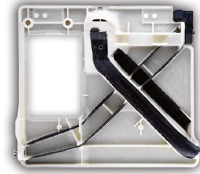
BILD 1 Ein Teil einer Pkw-Rückenlehne in E-LFT-Technik. Die schwarzen Endlosfaserprofile sind sowohl vertikal als auch horizontal entsprechend der Lastfälle positioniert (© Weber Fibertech)
