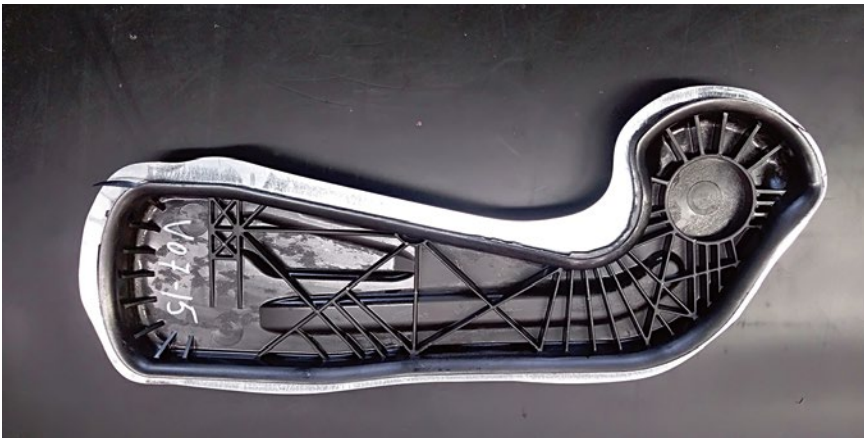
BILD 3 Der Querlenker, wie er aus der Presse kommt, also unbeschnitten (© Weber Fibertech)
